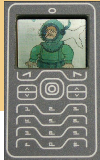
14 | הדגמת מסך הרטבה חשמלית של חברת ליקוויסטה (Liquavista) במכשיר אלקטרוני קטן.
