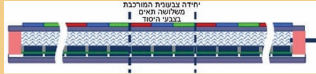
12 | פיקסל הרטבה חשמלית צבעוני שמורכב מחיבור של שלושה פיקסלים מונו-כרומטיים בצבעי היסוד האופטיים.
