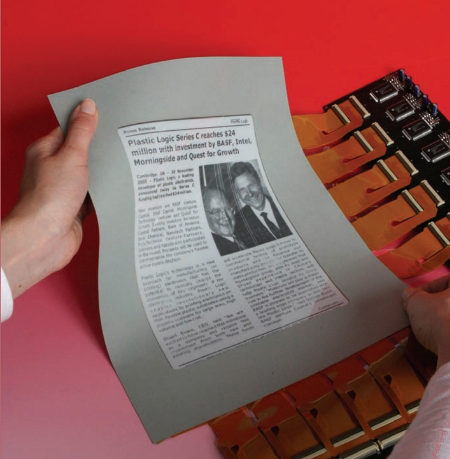
15 | המחשה של שימוש בנייר אלקטרוני לקריאת עיתון. זהו אב-טיפוס של חברת פלסטיק לוגיק (Plastic Logic) המבוסס על טכנולוגיית המיקרו-קפסולות.
