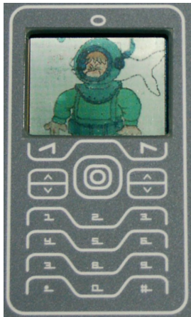
איור 15: הדגמת מסך הרטבה חשמלית של חברת ליקוויסטה (Liquavista) במכשיר אלקטרוני קטן.
