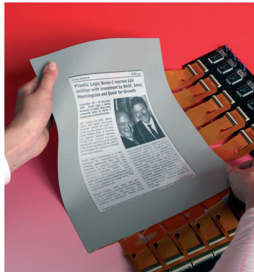
איור 14: המחשה של שימוש בנייר אלקטרוני לקריאת עיתון. זהו אב-טיפוס של חברת פלסטיק לוגיק (Plastic Logic) המבוסס על טכנולוגיית המיקרו-קפסולות.
